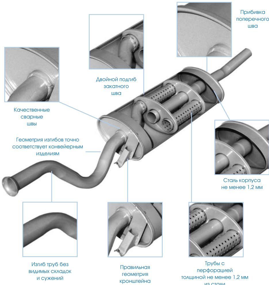
Внутренние части глушителя собираются и свариваются в специальных приспособлениях - кондукторах. Это обеспечивает постоянство заданных размеров и геометрических форм. Важная тонкость, сильно влияющая на ходимость глушителя: внутренности не следует приваривать к оболочке бачков. На заводе «Фобос» внутренности прессуются в готовую обечайку с натягом на зафасовочном прессе.
